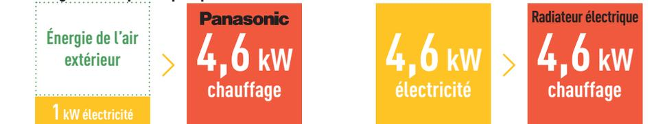
\* COP de 4,6 pour les modèles CU-2235TBE et CU-5290TBE ; le calcul des valeurs COP est conforme à la directive EN14511.
